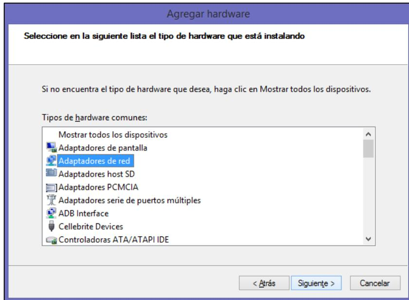
4. Seleccione en fabricante **Microsoft** y en adaptador de red **Adaptador de bucle invertido de Microsoft**, y de clic en siguiente para instalar el adaptador o interfaz virtual:
